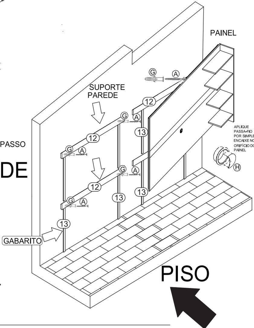
APLIQUE PASSA-FIO POR SIMPLES ENCAIXE NO ORIFÍCIO DO PAINEL.
