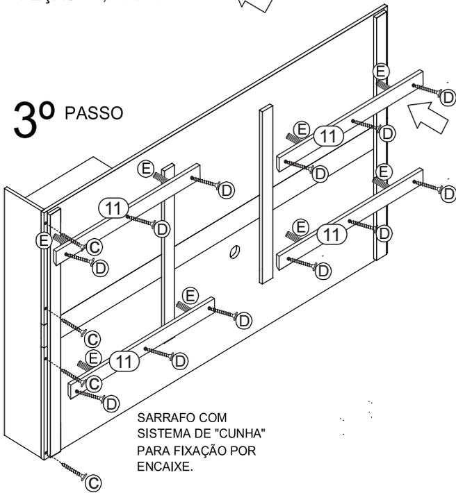
FIXAR ÀS CUNHAS PARA ENCAIXAR JUSTAMENTE COM ÀS PRÉVIAMENTE FIXADAS NA PAREDE.
