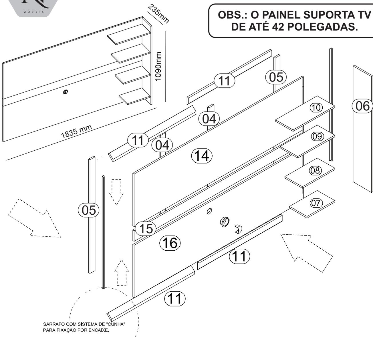
SARRAFO COM SISTEMA DE "CUNHA" PARA FIXAÇÃO POR ENCAIXE.
